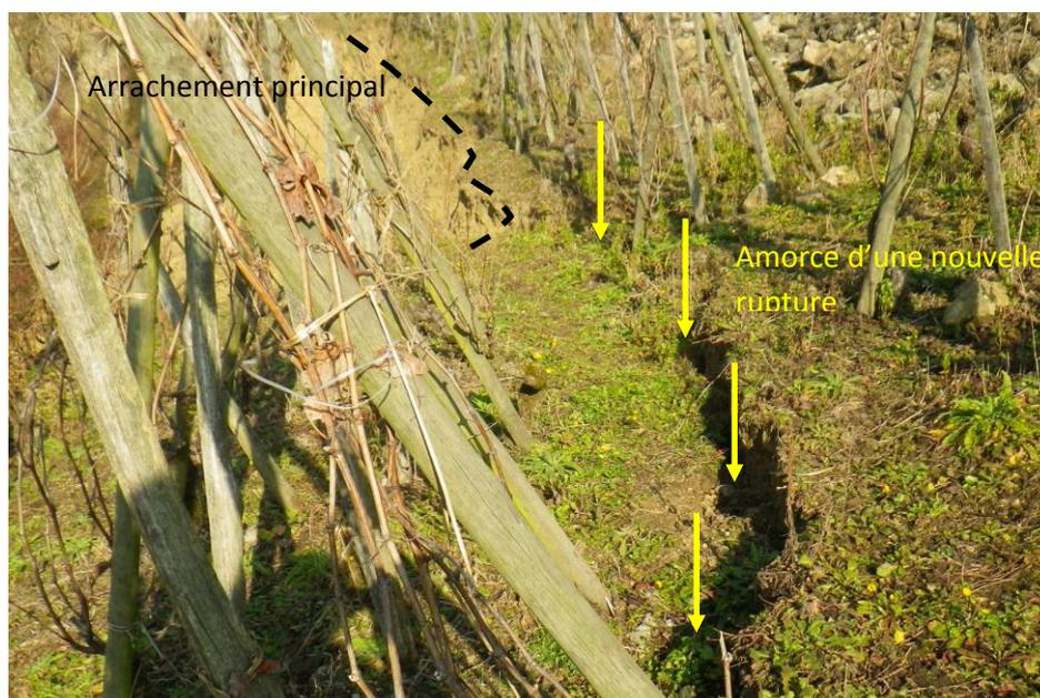
**Figure 13:** *vue de l'arrière de la tête du glissement*
