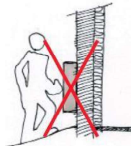
Élément non intégré à la façade
