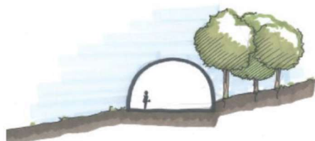
Tunnel agricole adossé à une haie ou à un boisement existant
