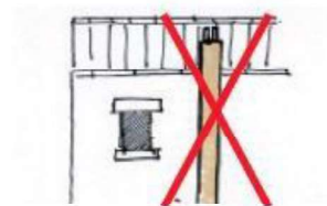
Cheminée en façade
